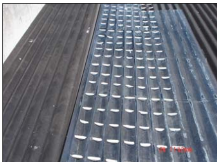
Fotografía N° 07: Prototipo con difusores de tecnopor espaciados cada 10 cm
